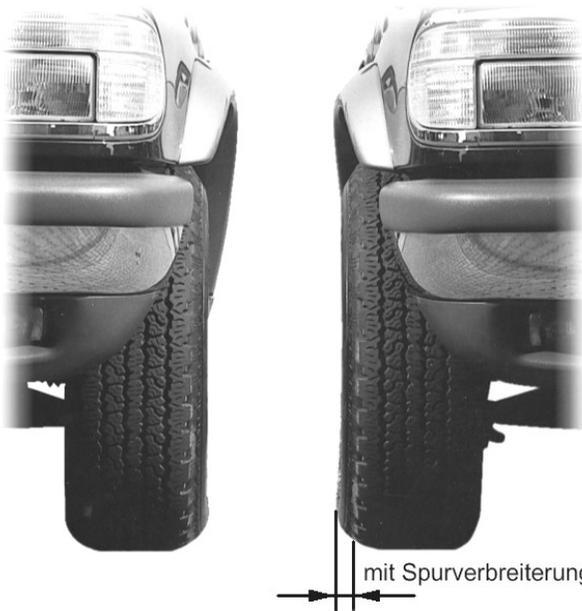
Passend für den Toyota Landcruiser 200 bieten wir Spurverbreiterungen in 28 mm und 32 mm pro Seite an, die optimal auf das Fahrzeug angepasst sind. Weitere Abmessungen auf Anfrage.
