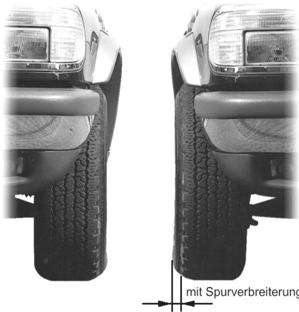
Passend für den SsangYong Rexton ( 6-loch ) bieten wir Spurverbreiterungen in 30 mm pro Seite an, die optimal auf das Fahrzeug angepasst sind. Weitere Abmessungen auf Anfrage
