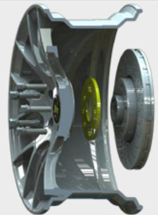
Dünne Spacer werden zwischen Felge und Radaufnahme positioniert und dann über längere Radschrauben fixiert.
