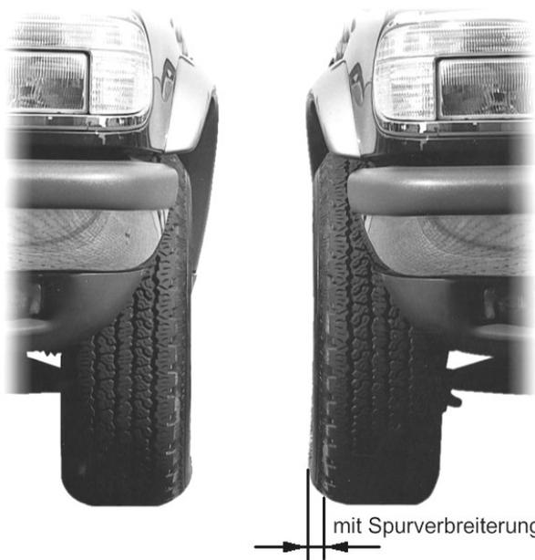
Passend für den Landrover Discovery 5 bieten wir Spurverbreiterungen in 15 mm, 18 mm, 21 mm, 25 mm und 30 mm pro Seite an, die optimal auf das Fahrzeug angepasst sind.
